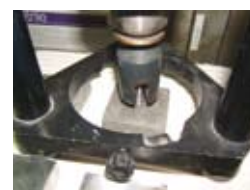
Tracción. Esfuerzo perpendicular al plano de adhesión
